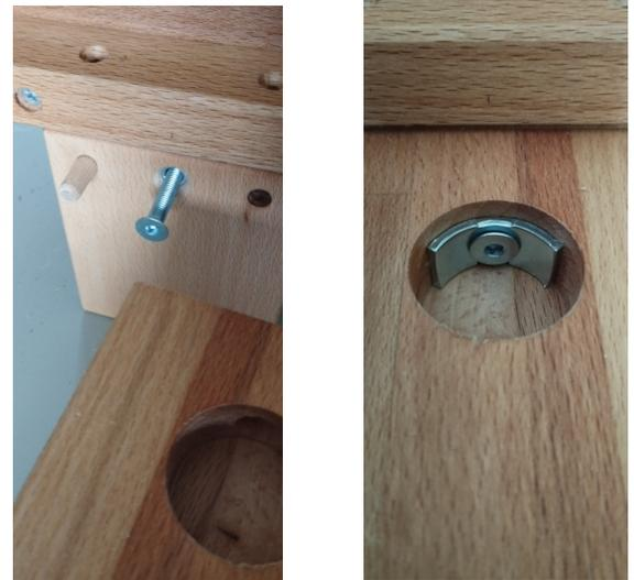
Zuletzt das Fußteil zunächst mit den Holzdübeln verbinden und die Schrauben wie oben fixieren.
